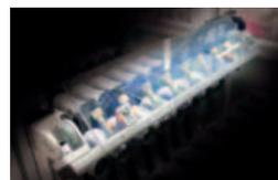
**Una barriera fotoelettrica a riflessione all'estremità di ogni alimentatore evita i danni meccanici all'impianto**
